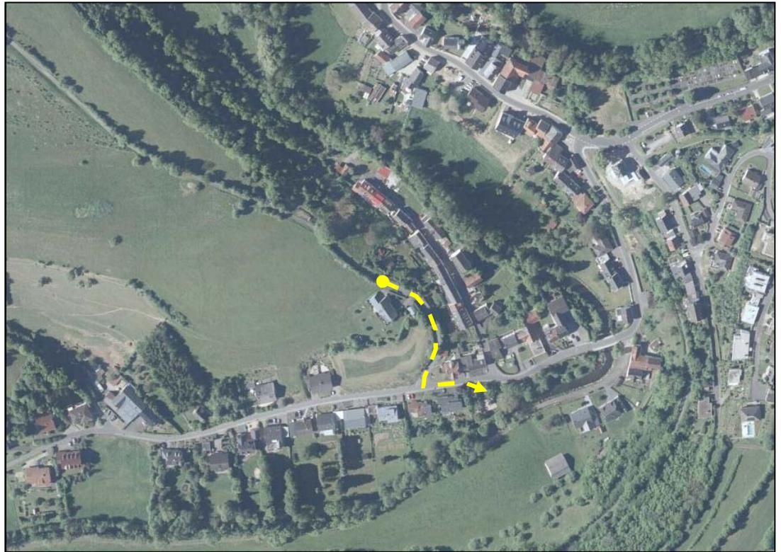
Herstellung und Unterhaltung eines Notabflussweges im Bereich der Straße „Im Nimstal“ bis zur Nims. Schutz der hiervon betroffenen Grundstücke (Im Nimstal 12) durch Lenkungsmaßnahmen (baulich oder temporär).
