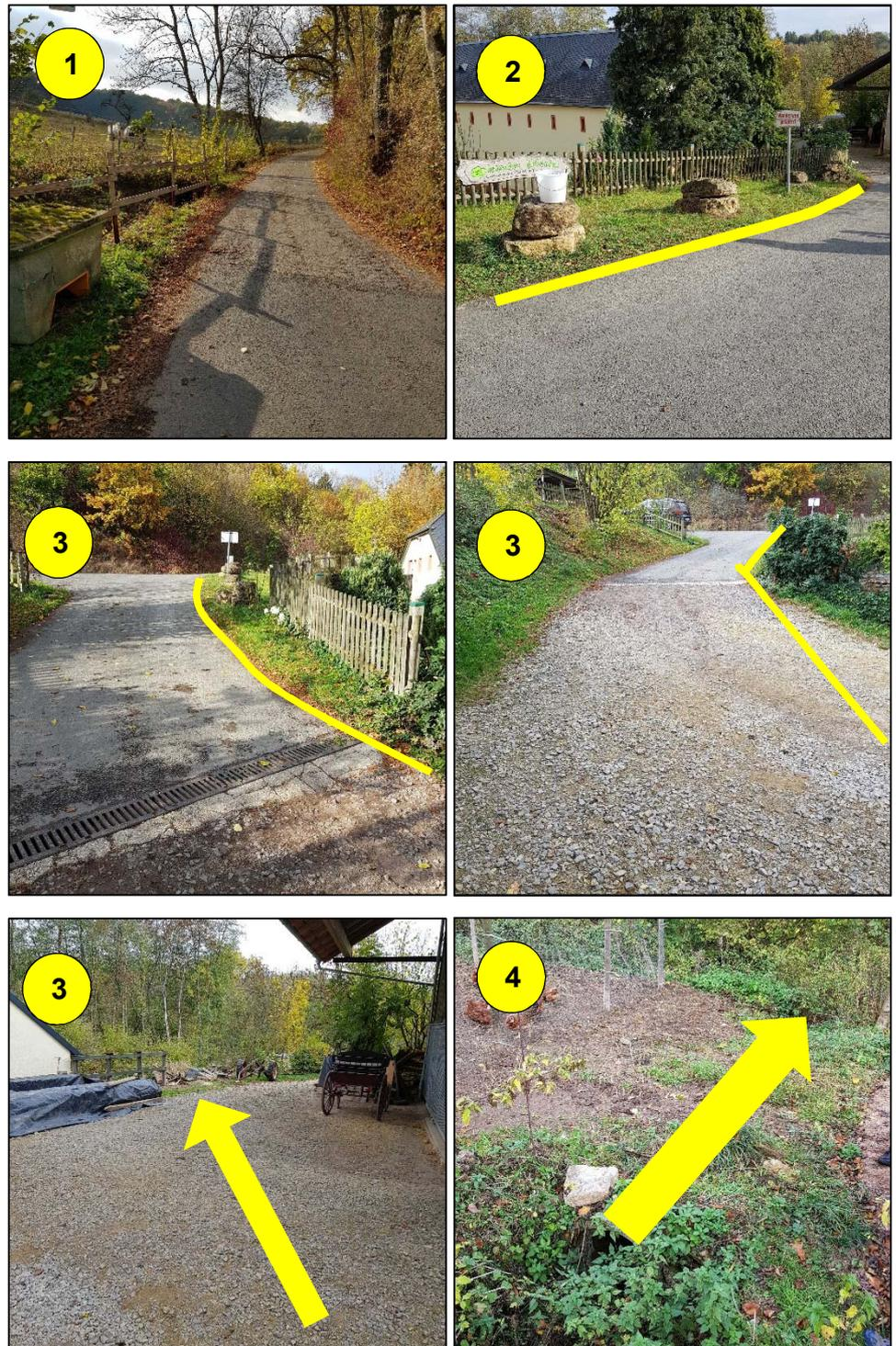
Im Bereich der Backesmühle „drückt“ ein großes Außengebiet auf die Bebauung. In der Vergangenheit ist es hier bereits zu Schäden gekommen. Die vorhandene Rohrleitung ist mit DN 300-400 zu klein dimensioniert.
